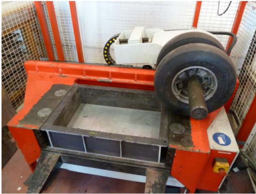
Figuur A: Voorbeeld van plaatverdichter met mal, voor het verdichten volgens NBN EN 12697-33
