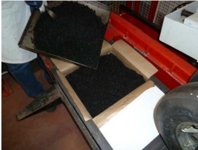
Figuur E: Aanbrengen van asfalt toplaag op proefstuk
