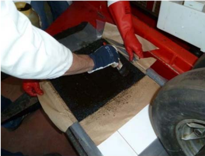
Figuur C: Aanbrengen emulsiekleeflaag op proefstuk
