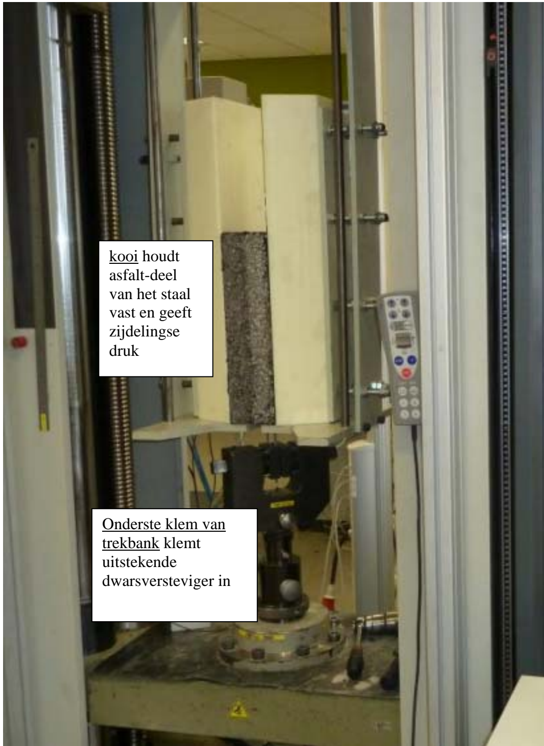
Figuur 4: Proefstuk ingebouwd in trekbank
