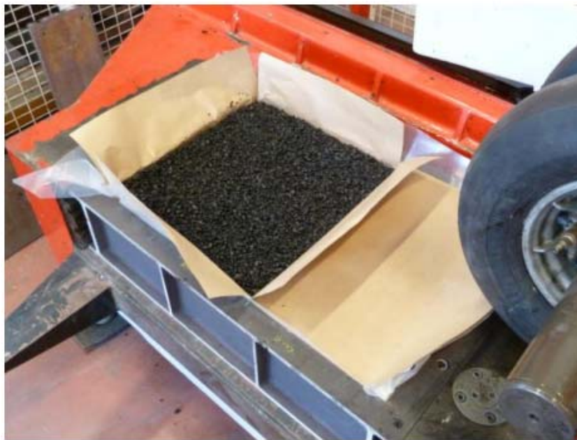
Figuur B: Proefstuk na verdichten bodem asfalt laag (bemerkt: rechts in mal geen asfalt voor uitstekende dwarsversteigers)
